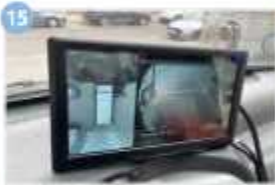
15 화물자동차 충돌재해예방설비 (후방카메라, 인체감지센서)
